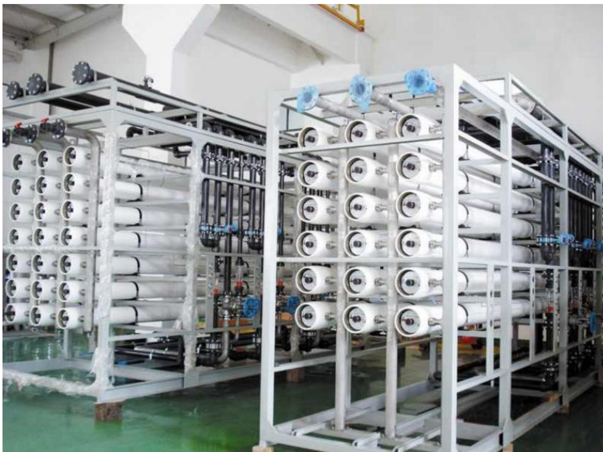
图 7.2-11 类似项目 RO 工艺工程图
